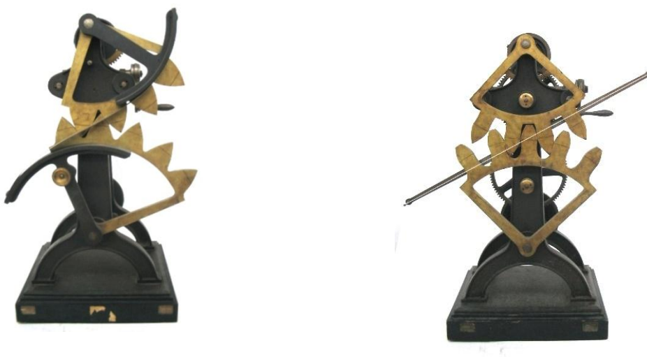
Fig. 1 – Modelos de cinemática do Sistema Reuleaux comprados para o Museu Tecnológico em 1883 (Museu do ISEP, Colecção de Objectos, nº inv. MPL411OBJ e MPL381OBJ)
